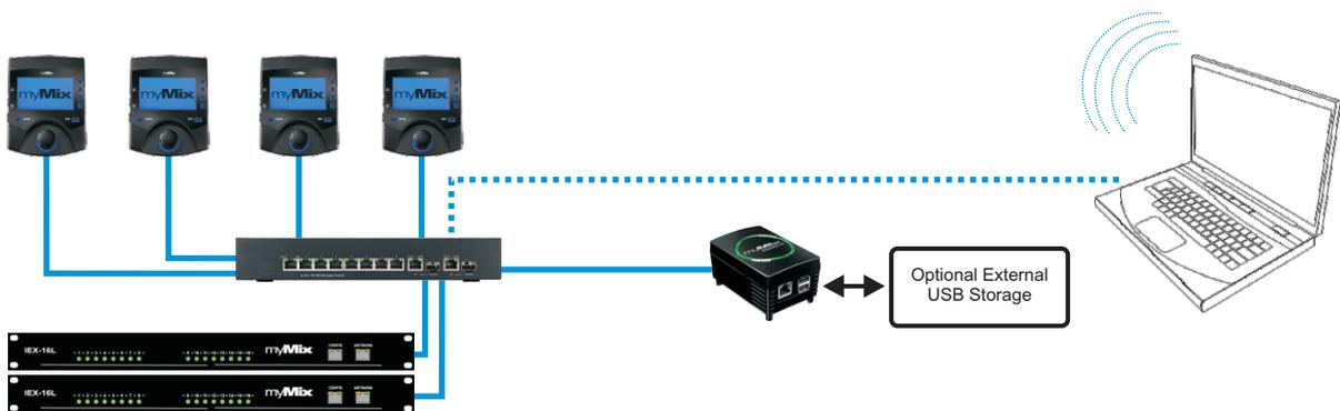
Das Netzwerk Interface myMix PLUG wird mit dem Netzwerk Switch verbunden. Der Client Computer mit der Web Browser Anwendung kann über eine CAT5 Ethernet -Verbindung mit dem Netzwerk oder über Wi-Fi direkt mit myMix Plug kommunizieren.
