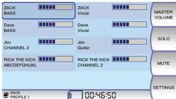
Kanäle werden mit dem Encoder Rad ausgewählt, Solo und Mute sind direkt verfügbar. Einmaliges Drücken des Encoders öffnet den Editor. Die Lautstärkeeinstellung erscheint als erstes, mit den Soft Keys können auch Klangfarbe, EffektSend und Panorama eingestellt werden.
