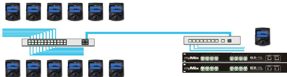
Mehr als zwei Switches werden über einen zentralen Gigabit Switch verbunden.
