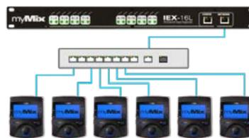
Werden zwei Switches verwendet, werden diese über die Gigabit Uplink Ports verbunden.
