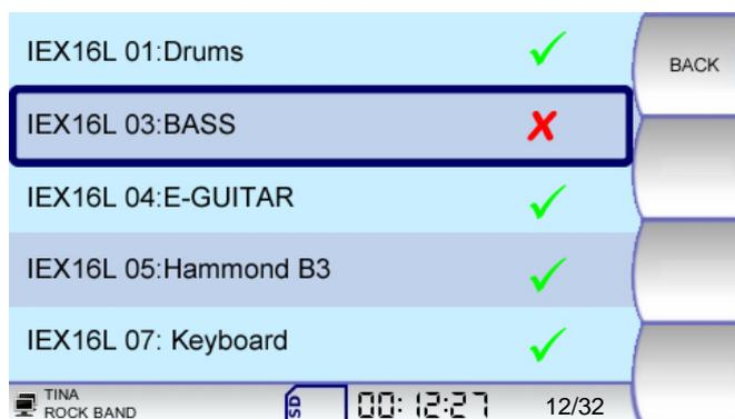
Unten rechts im Status Bar ist ein Kanalzähler. Er zeigt die aktuell gewählte Anzahl und die insgesamt verfügbaren Kanäle im Netzwerk. Da die Kanäle paarweise übertragen werden erfolgt auch die Anzeige nur in geraden Zahlen.
