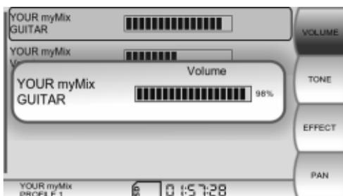
Lautstärkeeinstellung des Kanals „GUITAR“ durch Drehen des Jog-wheels[4]. Die relative Lautstärke wird durch den Bargraph symbolisch dargestellt.
