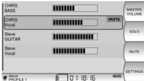
Ein roter MUTE Indikator in der Status Leiste zeigt an, das mindestens ein Kanal stumm geschaltet ist. Um MUTE auszuschalten, drücken Sie den Soft Key wieder. Durch Halten des Soft Keys für ca. 3 Sekunden werden alle MUTE Funktionen zurückgesetzt.
