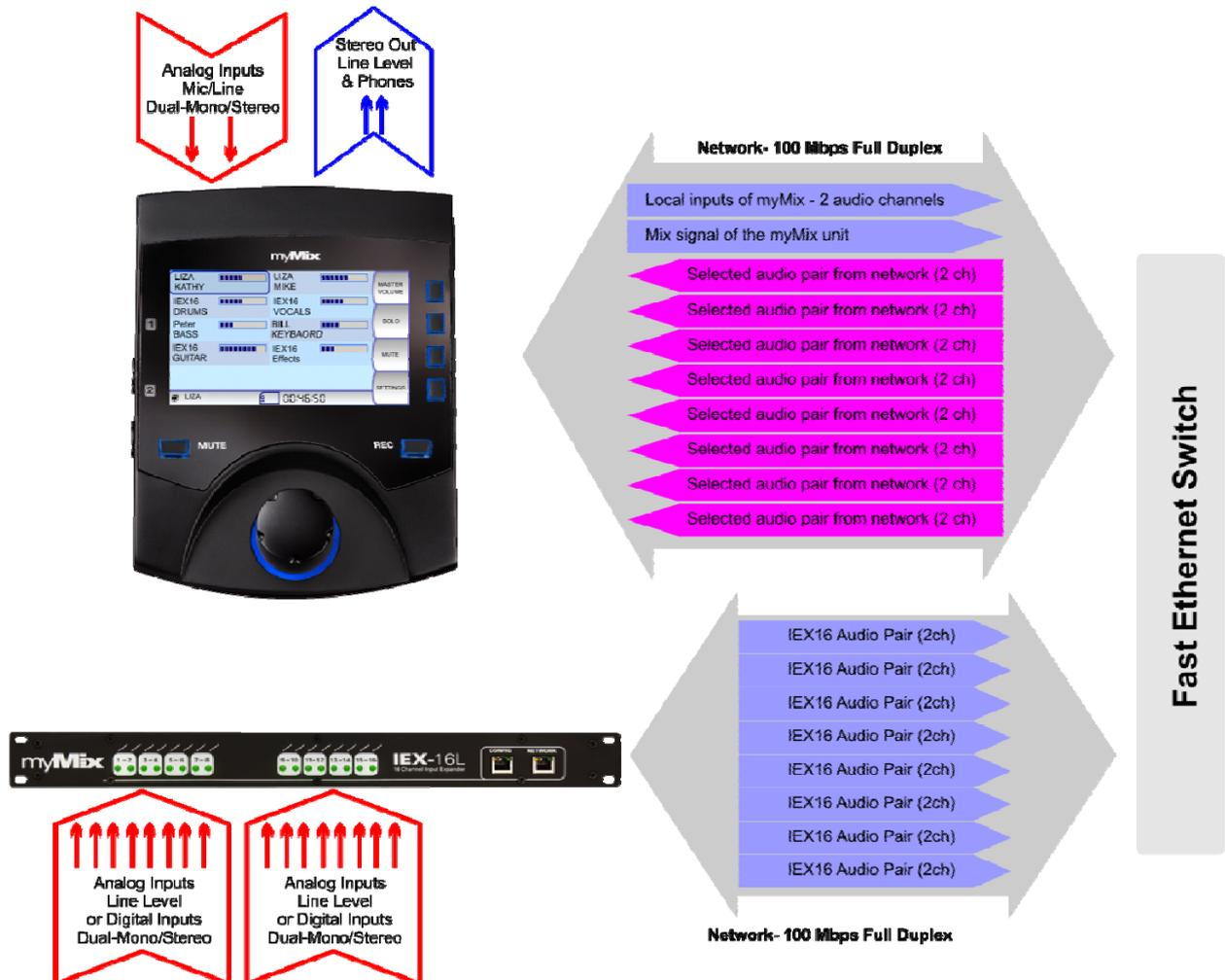
Cada myMix tiene dos entradas locales para micrófono y para Fuentes de nivel de línea. Estos son conducidos a la red y pueden ser seleccionados por cada otro myMix. La señal de salida de la mezcla esta disponible como de nivel línea analógica y de salida de audífono y puede ser seleccionada tambien para ser enviada a la red. Esta mezcla de señal stereo, puede ser seleccionada desde otros dispositivos de myMix y ser usadas como cualquier otra señal de entrada.
