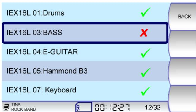
El contador de canales en el lado derecho de la barra de control está mostrando la cantidad de canales seleccionados y la cantidad de canales de audio actualmente disponibles en la red. Porque desde la corriente de audio en pares este indica que se está solo mostrando figuras que son niveladas.
