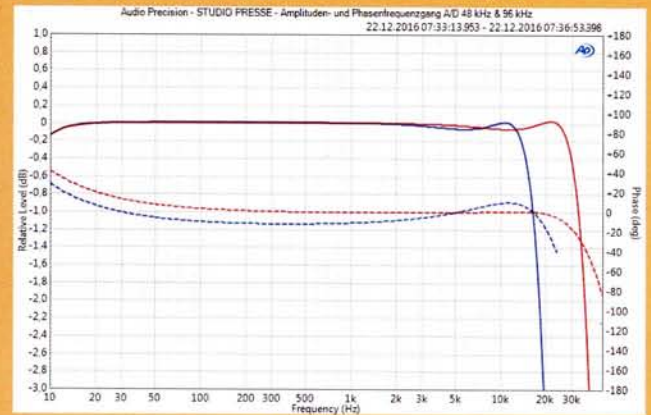
Diagramm 10: Amplituden- (solide) und Phasenfrequenzgang (gestrichelt) des Anti-Aliasing-Filter Slow bei 48 kHz (blau) und 96 kHz (rot) Abtastrate
