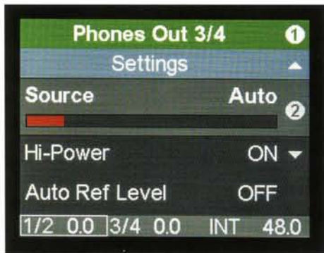
Abbildung 4: Die Grundeinstellungen der Kopfhörerausgänge erlauben auch die Umschaltung zwischen Low und High Power-Betrieb
